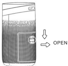
1. Öffnen Sie die Verriegelung um die Klappe abzunehmen.
